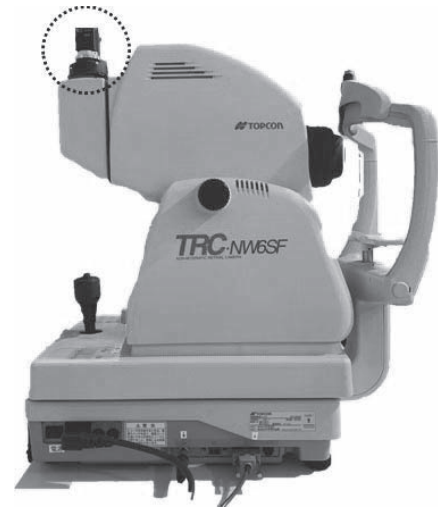
図1 眼底ハイパースペクトルイメージング装置の外観写真。（丸点線部がハイパースペクトルカメラ）
